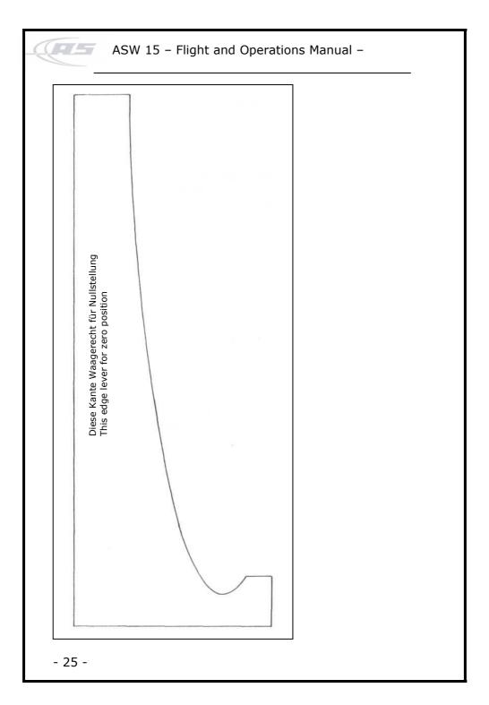
Schablone zur Err Pendelruder-Nulls Anlegen auf die C Wurzelrippe. M=
